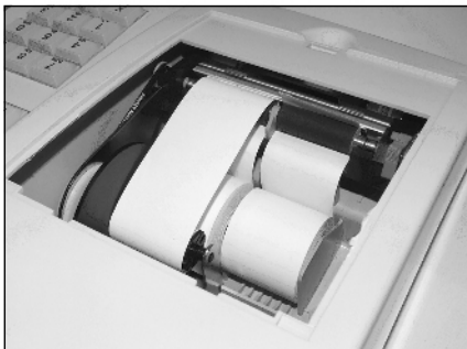
Izgled pravilno postavljenih termalnih traka
