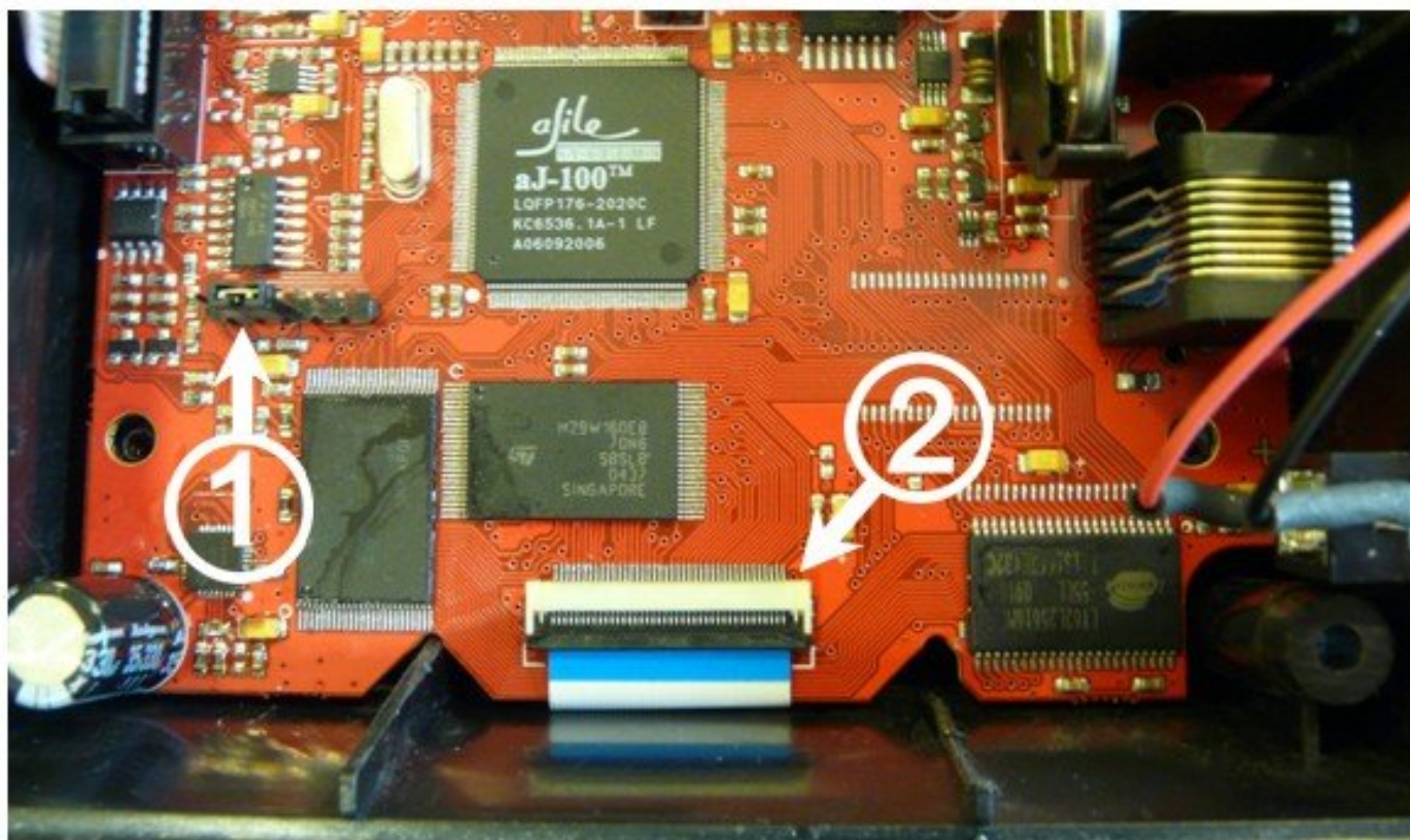
Slika 1. – Izgled ploče i mesto postavljanja plombi
