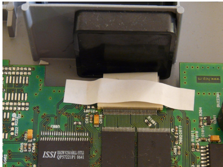
Slika 3. – izgled postavljene plombe, plomba se postavlja preko konektora na način koji onemogućava zamenu fiskalne memorije bez skidanja fiskalne plombe
