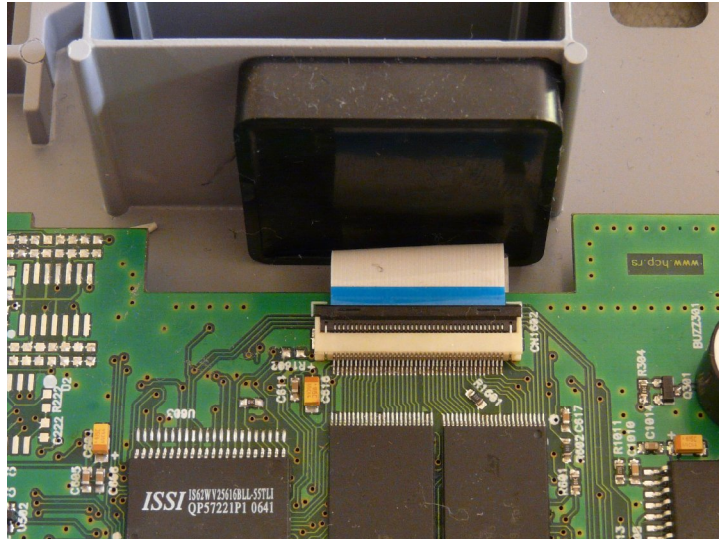
Slika 2. – konektor za povezivanje fiskalne memorije
