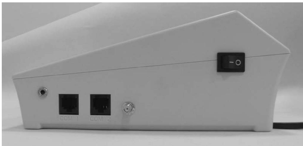
Slika konektora s leva u desno: za Fioku, PC, Bar Code skener, GSM antenu
